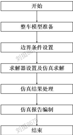
图1 整车热害仿真分析流程
