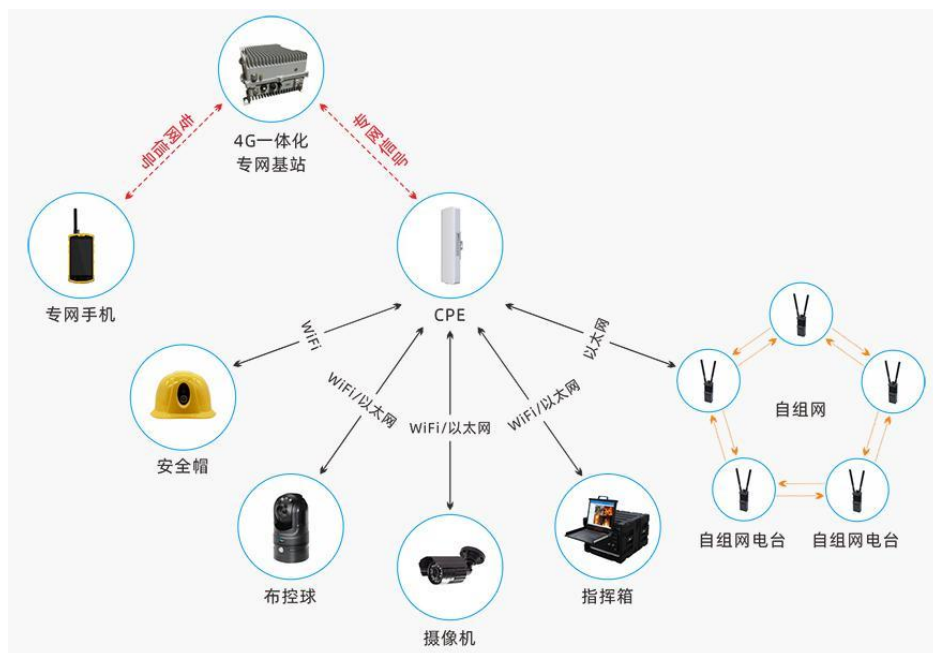
图 4 通信一体化专网基站结构图
