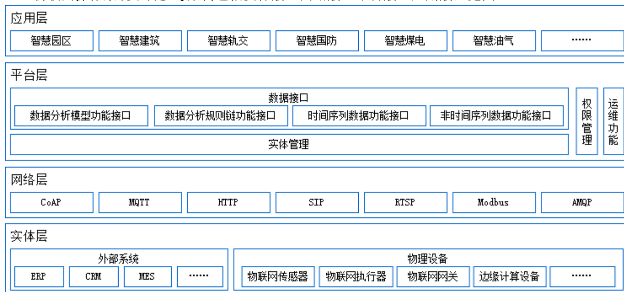
图 1 物联网操作系统平台参考架构
