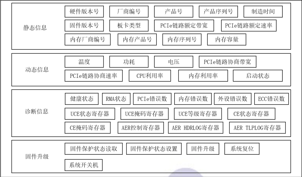
图 2 人工智能加速卡管理接口功能架构
